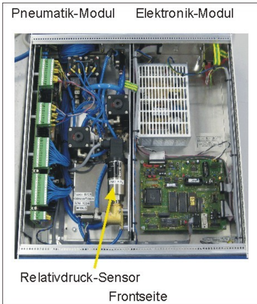
Relativdruck-Sensor im Pneumatik-Modul
