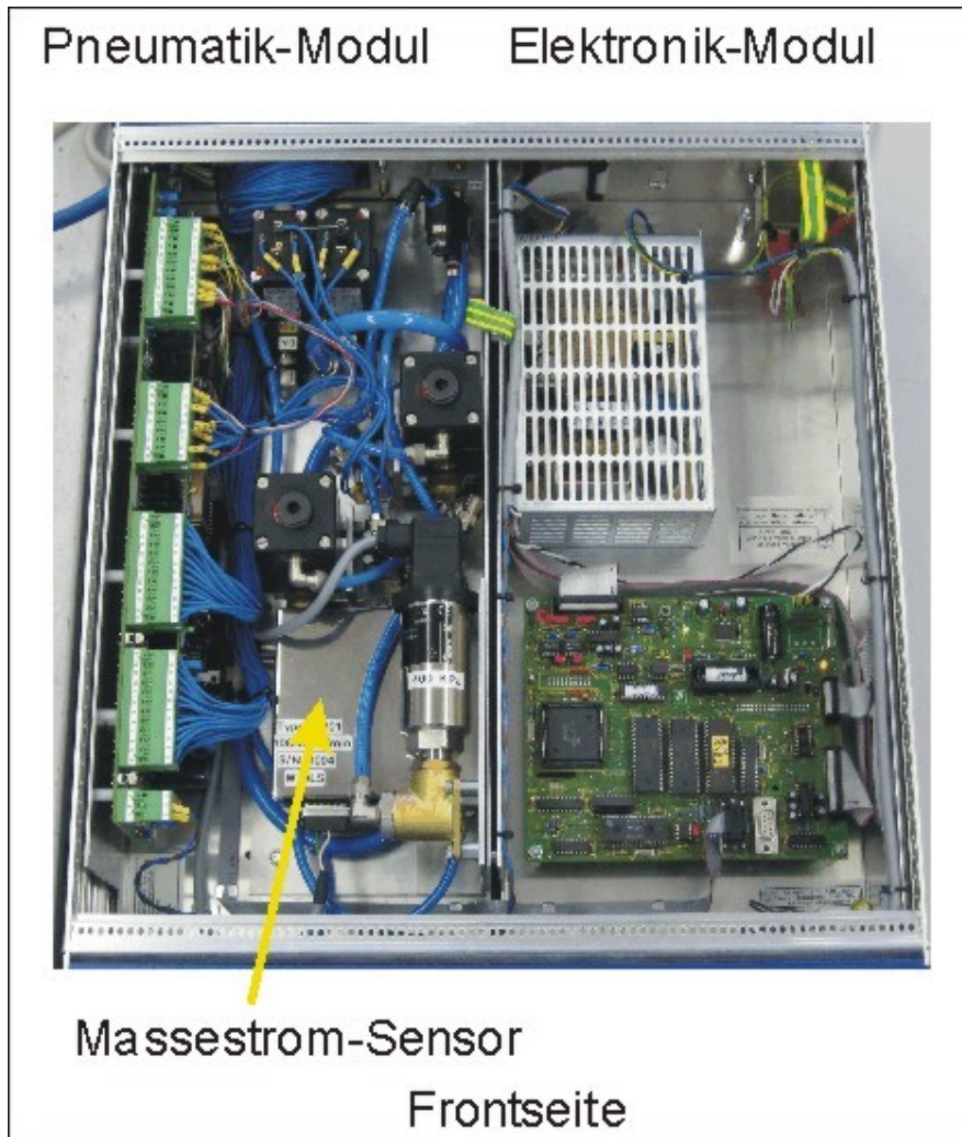
Massestrom-Sensor im Pneumatik-Modul
